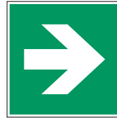
Richtungszeichen für Erste-Hilfe-Einrichtungen, Rettungswege, Notaus- gänge Direction for first-aid facilities, emergency routes and emergency exits
