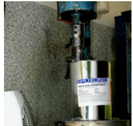
Bild 4: Harzaufbereitung nach Verfahrenshandbuch auf der Baustelle.
