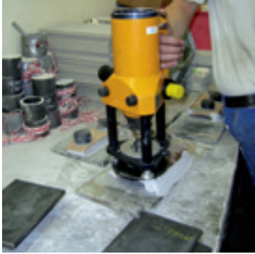
Bild 1: Haftzugnachweise im Baustofflabor.
