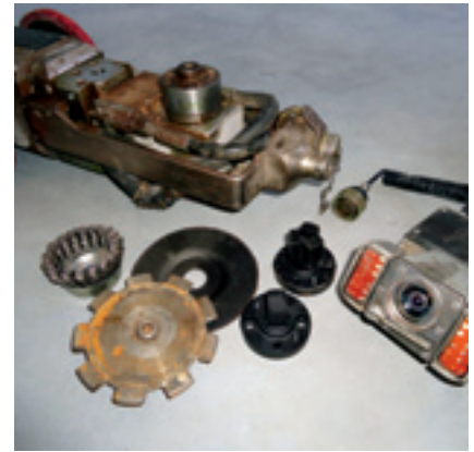
Bild 3: Spezielle Fräsköpfe für die Muffenspaltbearbeitung.
