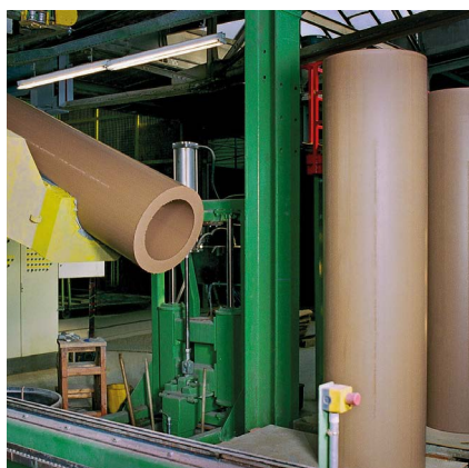
Usinage des tuyaux
