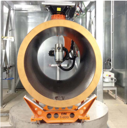
Fraisage et sciage au millimètre près
