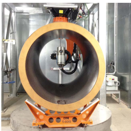
Foraj și frezare cu precizie milimetrică
