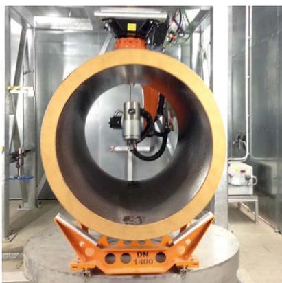
Millimetergenaues Fräsen und Sägen
