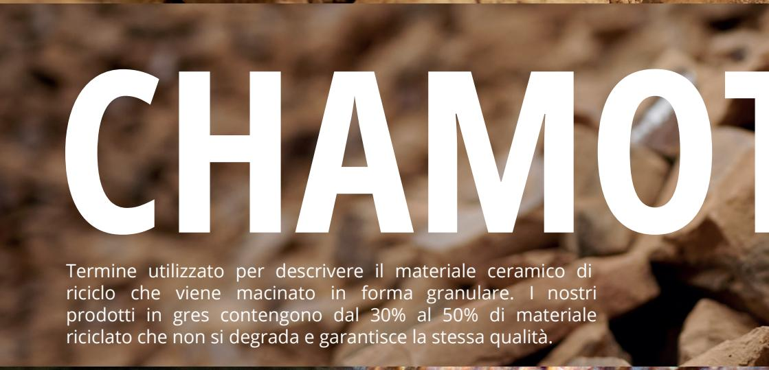
Termine utilizzato per descrivere il materiale ceramico di riciclo che viene macinato in forma granulare. I nostri prodotti in gres contengono dal 30% al 50% di materiale riciclato che non si degrada e garantisce la stessa qualità.
